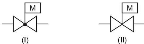
As válvulas de controle, quando representadas nos diagramas hidráulicos, recebem uma simbologia própria normalizada (ANSI) para indicar o tipo de seu acionamento.
