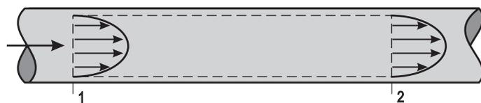
Um gás ideal escoa em regime permanente na tubulação ilustrada acima. Na seção 1,  $P_1 = 500 \text{ kPa}$  e  $T_1 = 300 \text{ K}$ . Na seção 2,  $P_2 = 100 \text{ kPa}$ ,  $T_2 = 200 \text{ K}$ , e a velocidade média do fluido,  $\bar{V}_2$ , é de  $400 \text{ m/s}$ .
