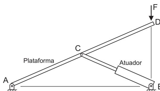
O mecanismo de movimentação de uma plataforma de carga é acionado por um atuador hidráulico, conforme esquematizado na figura acima. Considerando-se a fase indicada, em que o mecanismo não está em movimento e suporta uma força  $F$  na extremidade D da plataforma, a força resultante suportada pelo mancal A é
