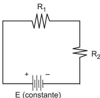
Considere que o circuito constituído de dois resistores ( $R_1$  e  $R_2$ ), mostrado na figura acima, seja alimentado por uma fonte de tensão constante,  $E$ . Nessa situação, qualquer alteração na tensão de entrada da fonte é sentida, imediatamente, pelos resistores  $R_1$  e  $R_2$ . Se o resistor  $R_2$  for substituído por um capacitor inicialmente desenergizado, as tensões entre os terminais do resistor  $R_1$  e do capacitor tenderão, de forma assintótica, respectivamente, aos valores
