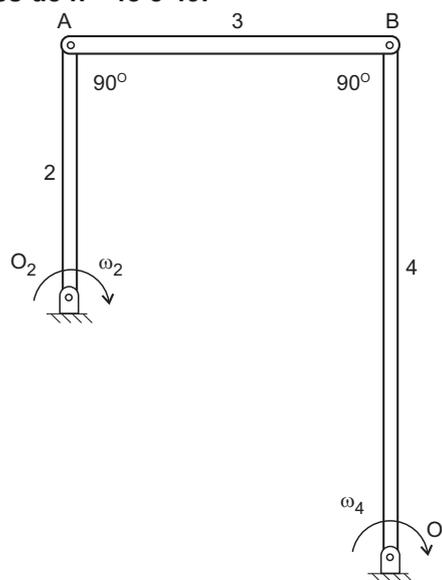
No mecanismo de quatro barras da figura, a barra  $O_2A$  é acionada por um motor acoplado ao mancal  $O_2$  a uma velocidade angular constante  $\omega_2$ . Considere a fase indicada na figura e que os comprimentos das barras paralelas sejam tais que  $O_4B = 2 O_2A$ .
