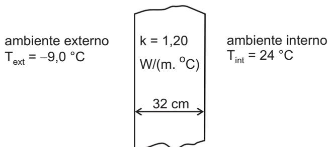
Após realizar os cálculos, considerando a condutividade térmica apresentada para o material da parede, o engenheiro obterá para os coeficientes de película interno e externo, respectivamente, em  $\text{W}/(\text{m}^2 \cdot ^\circ\text{C})$ ,
