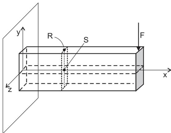
Uma viga engastada-livre é solicitada por uma força  $F$  em sua extremidade, conforme mostrado na figura. Considere uma seção interna da viga onde podem ser identificados dois pontos, R e S. O plano  $xz$  é o plano neutro da viga. Em relação ao estado de tensões atuantes nesses pontos tem-se que no ponto
